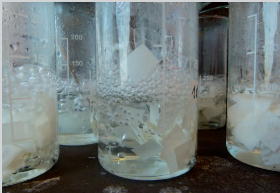
Abb. 3: Messung der alkalischen Reserve – Probenstücke des zu untersuchenden Papiers werden in einer Salzsäurelösung aufgekocht (Bildquelle: ZFB)
