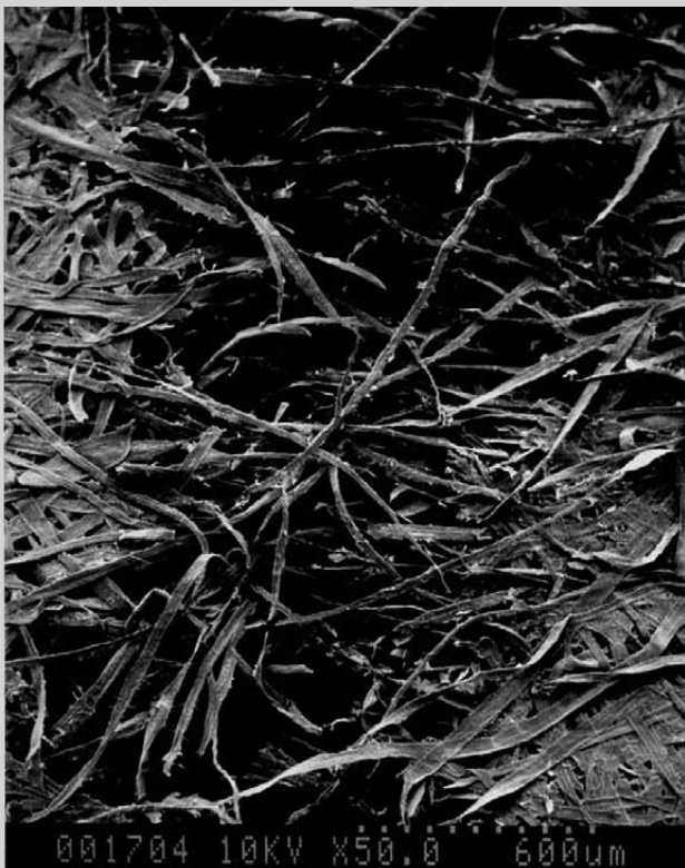
Abb. 2: REM-Aufnahmen der Abrisskante eines Zellstoffpapiers vor (links) und nach (rechts) künstlicher Alterung (Bildquelle: Anders 2000)
