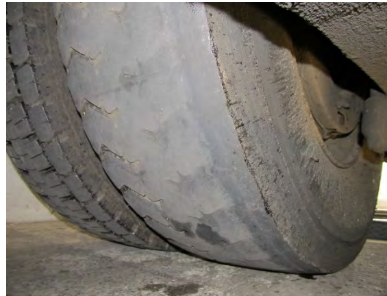
Foto: KPB Mettmann, Direktion Verkehr hier: nicht ausreichende Profiltiefe
