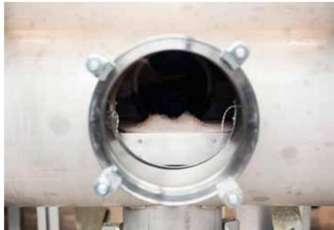
Wie verhält sich Marsstaub? Als Ersatz verwirbelt Professor Wurm Staub aus der amerikanischen Mojave-Wüste. Die Körner haben die gleiche Größe (Bild oben). Hier steckt Mars-Atmosphäre drin (Bild rechts): CO<sub>2</sub> und geringer Druck. Die Kammer kann sich drehen und beim Parabelflug Mars-Gravitation nachahmen.
