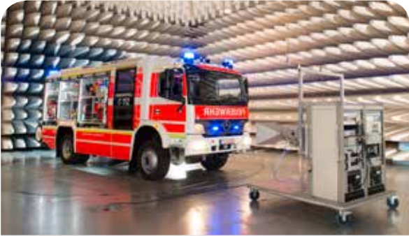
EMV-Test des neuen HLF Foto: EMC-Test NRW
