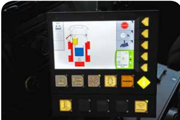
Die Kontrollanzeige zeigt dem Maschinisten vom Fahrersitz schon wie voll die Tanks sind oder welche Gerätefächer offen sind. Foto: Jürgen Truckenmüller
