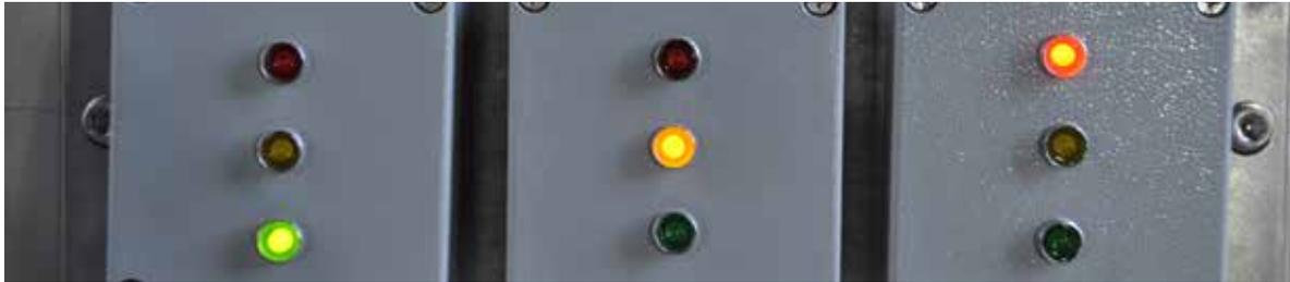
Wird für einen Messwert die erste Alarmschwelle erreicht, wechselt die Anzeige nach gelb und signalisiert dem Ausbilder: Handlungen einleiten! Jetzt kann der Ausbilder entweder die Flammenintensität beeinflussen, einen einsatztaktischen Rückzug anordnen oder beispielsweise eine kurze Erläuterung geben.
