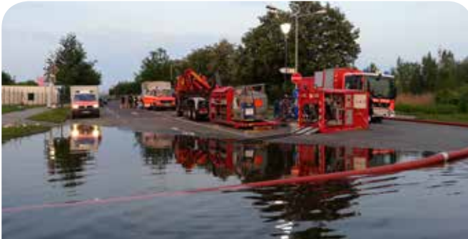
AB Wasserförderung der Feuerwehr Düsseldorf hier im Einsatz in der überörtlichen Hilfe in Magdeburg im Sommer 2013. (Foto: Feuerwehr Düsseldorf)
