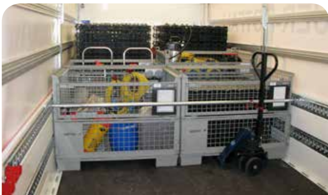
Stromerzeuger inkl. Lichtmast auf Rollwagen (davon verfügt die Feuerwehr Düsseldorf über mehrere baugleiche für verschiedene Anwendungszwecke) sowie Rollwagen mit Hochdruckreiniger für den Beladesatz DekonG. (Foto: Feuerwehr Düsseldorf)
