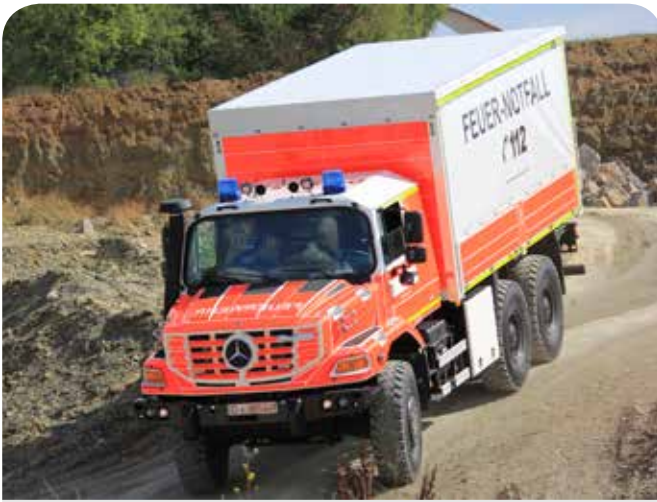
Beginn der Abnahmefahrt mit dem Zetros im Gelände. Die Dachbeschriftung nach DIN 14035 ist wegen der Schiebefläche auf dem Führerhaus angebracht. (Foto: Feuerwehr Düsseldorf)
