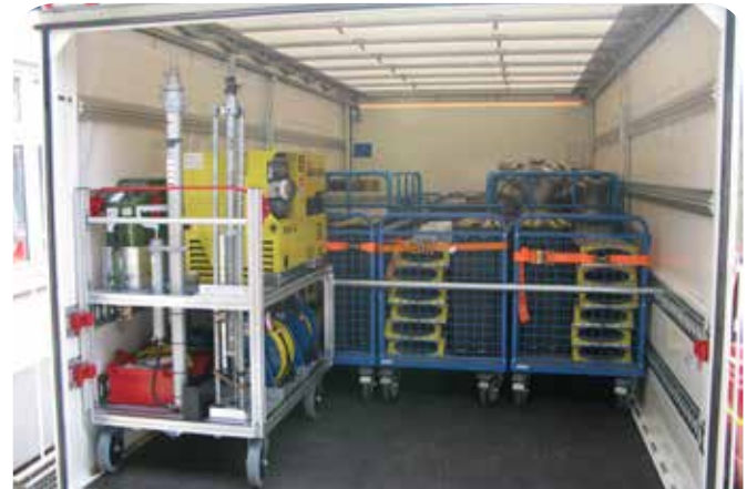
Beladesatz Wasserfördersystem-Zubehör. Hinten rechts F-5-B-Verteiler auf Rollwagen mit Armaturen, F-Druckschläuche, davor mehrere Rollwagen mit Schlauchbrücken. (Außerdem – im Bild nicht erkennbar – 2 Fahrräder zum Abfahren und zur Kontrolle der ggf. längeren Schlauchstrecken.) (Foto: Feuerwehr Düsseldorf)
