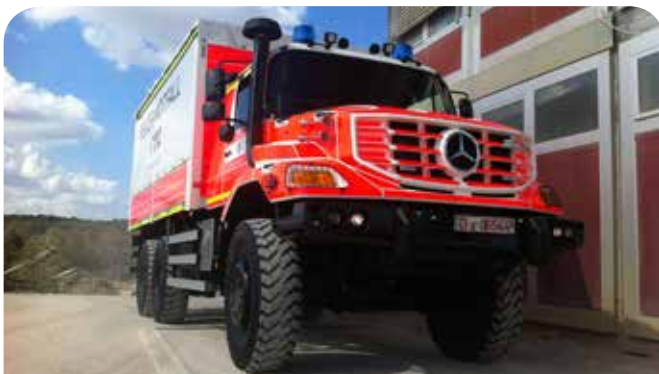
Gut erkennbar die Bodenfreiheit, Fahrzeug steht auf einer LKW-Waage mit der die Gewichte (Gesamt, Seitenverteilung) bei der Abnahme überprüft wurden, hier gerade Wiegung der Vorderachslast. (Foto: Feuerwehr Düsseldorf)
