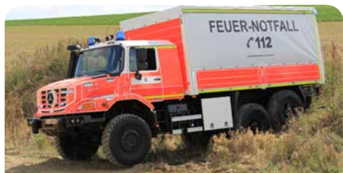
Test der Verschränkung im Gelände, anschließend wurden alle Klappen und die LBW geöffnet und geschlossen, um die einwandfreie Funktionalität zu überprüfen. (Foto: Feuerwehr Düsseldorf)
