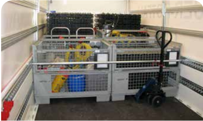
Teile der DekonG-Beladung im Zetros verladen, hier im Hintergrund die Bodenplatten für die Fahrstraßen zur Desinfektion auch von LKW, davor links die Bügel der beiden Zumischanlagen für Desinfektionsmittel, Drucksprühgeräte, Handwerkzeug, Kabel etc. Gut zu erkennen ist die Schiebeplane (oben) und die verschiedenen Schienen für Ladungssicherungselemente seitlich. (Foto: Feuerwehr Düsseldorf)
