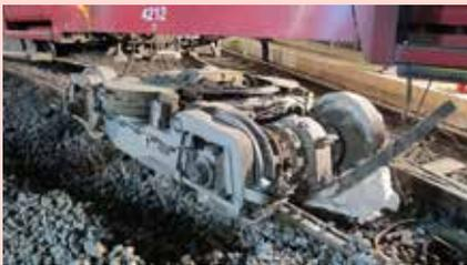
Abb. 15: Die Bahn wird Drehgestell für Drehgestell eingeleist. Am Schluss wird das lose Drehgestell mit einem Kran auf das Gleis gehoben und anschließend die Bahn mit Kran und Schiebebetrieb vorsichtig und behelfsmäßig darauf abgesetzt und später in langsamster Fahrt in eine in der Nähe befindliche Wendeschleife verfahren. (Fotos: Feuerwehr Düsseldorf)
