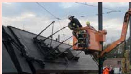
Abb. 7: Abtrennen überstehender Teile, hier defekter Stromabnehmer in Zusammenarbeit von Feuerwehr und Rheinbahn. (Foto: Feuerwehr Düsseldorf)
