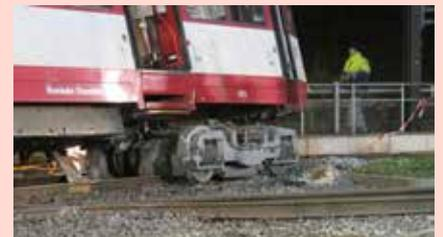
Abb. 14: Das vordere Drehgestell ist komplett abgerissen. (Foto: Feuerwehr Düsseldorf)
