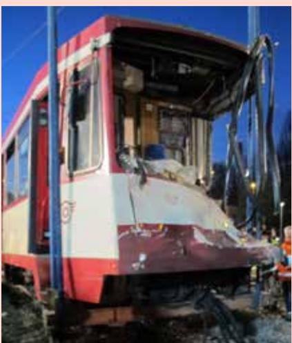
Abb. 11.a und b: Gerade hat der „Bergungs-Zug“ mit einer intakten Straßenbahn für den hinteren Teil der Bahn Erfolg gehabt. Die Bahnen sind wieder getrennt. Im zweiten Bild ist der Ausschnitt am Führerstand der hinteren Bahn zu erkennen, der zur Ermöglichung der Bergung geschaffen werden musste. Anschließend wurde der hintere Zugteil
