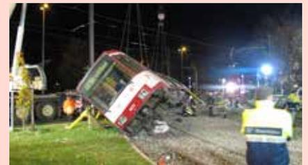
Abb. 13: Erster, schräg stehender und komplett entgleister Teil der betroffenen Bahn ist hier bereits an zwei Kränen angeschlagen und leicht angehoben. Die Stützen werden ausgebaut. (Foto: Feuerwehr Düsseldorf)
