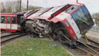
Abb. 5: Gut zu erkennen, wie schräg der komplett entgleiste erste Teil der Bahn steht und wie schwer die Schäden an den beiden Bahnteilen sind bzw. wie tief sich die Bahnen in das Schotterbett eingegraben und ineinander verhakt haben. (Foto: Feuerwehr Düsseldorf)
