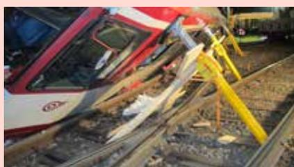
Abb. 9: Verschwertete Peri-Stützen, die damit nicht mehr umfallen können, wenn sie kurzzeitig entlastet werden. – Die Gelenkköpfe der Stützen sind eine Entwicklung eines Kollegen aus der FRW 10. (Foto: Feuerwehr Düsseldorf)
