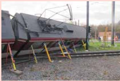
Abb. 2a. und b: Weiterer Ausbau der Abstützung dann auch mit Peri-Baustützen vom RW 3 bzw. AB Bau. (Foto: Dr. Cimolino, Feuerwehr Düsseldorf)
