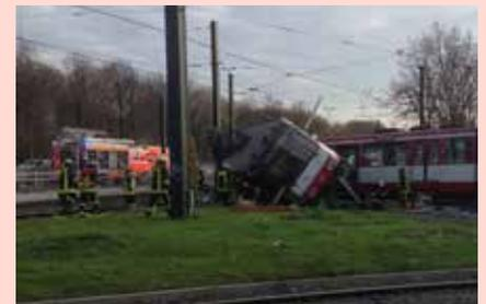
Abb. 1: Bereits in der ersten Phase mit Stabfast und Holzbohlen (Beladung HLF 20) provisorisch abgestützte schräg liegende Straßenbahn (der erste entgleiste Teil). Noch sind Patienten in der Bahn. (Foto: Dr. Cimolino, Feuerwehr Düsseldorf).
