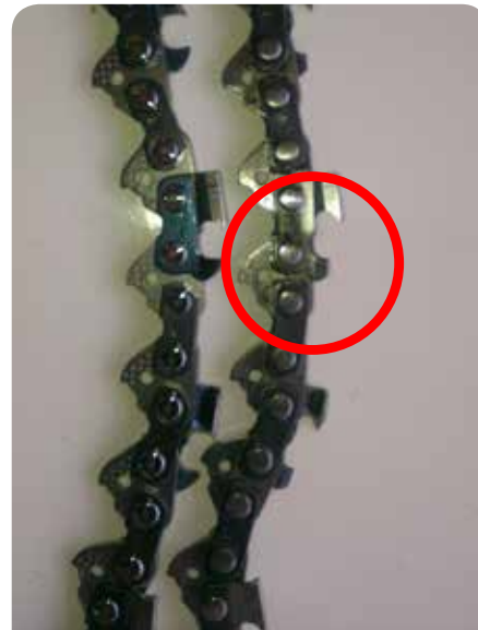
Erhöhte Unfallgefahr aufgrund zu weit heruntergefeilten Tiefenbegrenzer
