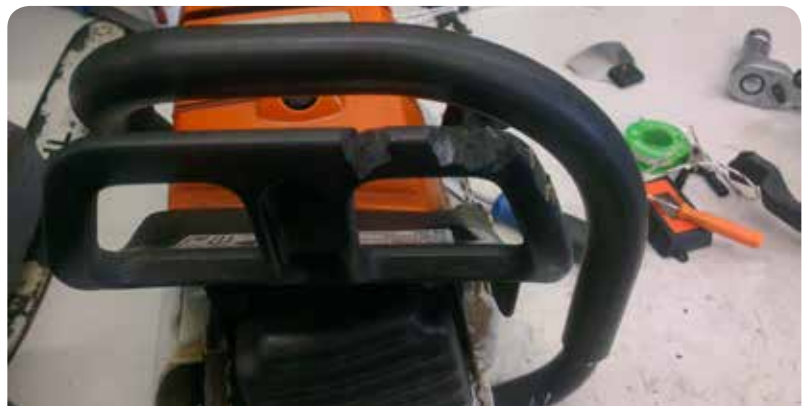
Beschädigung am vorderen Handschutz - verursacht durch andere Sägen
