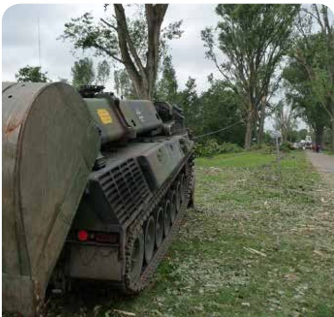
Pionierpanzer „Dachs“ im Einsatz
