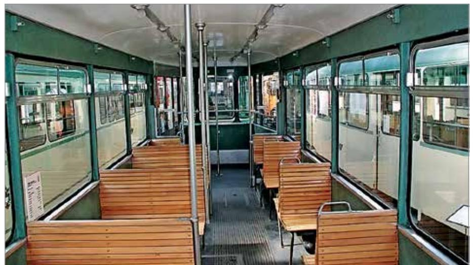
Der Aufbauwagen 1872 stellt ein Provisorium dar. 1950 bei Westwaggon gebaut, elektrisch ausgerüstet von BBC und SSW, sollte er die im Krieg entstanden Defizite im Fahrzeugpark ausgleichen – in Köln existierten von um die 1.000 Straßenbahnwagen nach dem Krieg noch 37. Die Fahrgestelle der sieben gebauten Wagen dieses Typs stammten von den sogenannten Tonnendachwagen, von denen kein Exemplar den Zweiten Weltkrieg überstand.
