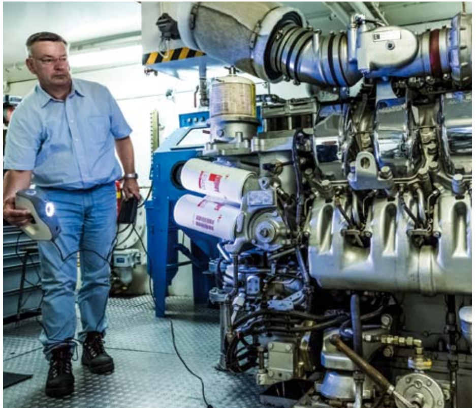
Knut Lehmann mit einem Handscanner bei der Dokumentation im Maschinenraum des Schiffes
