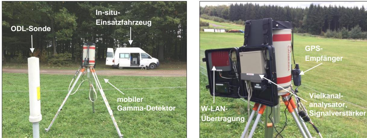
**Abbildung 5.6:** In-situ-Messung an einer ODL-Sonde bei Siegen.
