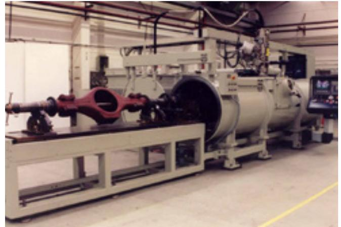
Sondermaschine zum Schweißen von LKW-Achsen (PTR-Präzisionstechnik GmbH)
