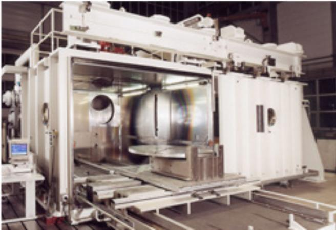
Haupteinsatzgebiet von Kammermaschinen ist die Einzelbearbeitung größerer Werkstücke mit komplexen Schweißnahtgeometrien (Steigerwald Strahltechnik GmbH)
