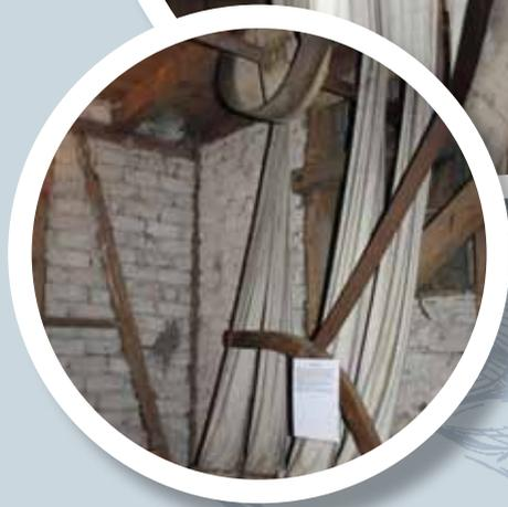
fällt dabei Mehl in unterschiedlichen Qualitäten an. Vier bis fünf Durchgänge waren keine Seltenheit“, so der Mühlenbesitzer. Aufgrund dieser typischen Verfahrensweise nennt man die halbautomatische Mühle auch Rückschüttmühle.
