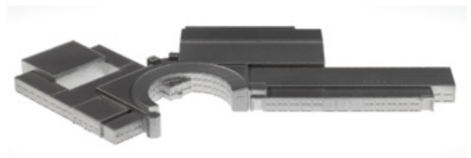
Ein Modell des LZH-Gebäudes aus Aluminium, das mittels Selektivem Laserstrahlschmelzen (SLM®) gefertigt wurde.
