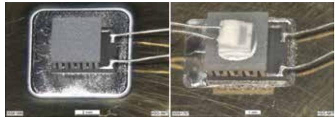
**Reaktiv gefügte Peltierelemente auf Cu-Wärmesenke, links: mit RMS-Beschichtung, rechts: mit RMS-Folie.**
