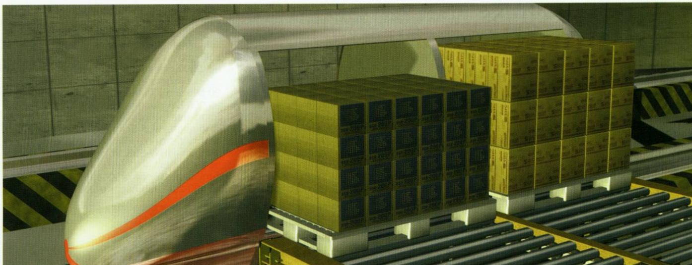
Eine Frachtdrohne wird beladen: Jeweils zwei Europaletten passen hinein. Der elektrische Vortrieb erfolgt über Drehstrommotoren mit einer Spannung von 500 Volt. Führerlos sucht sich anschließend die Drohne selbstständig den Weg
