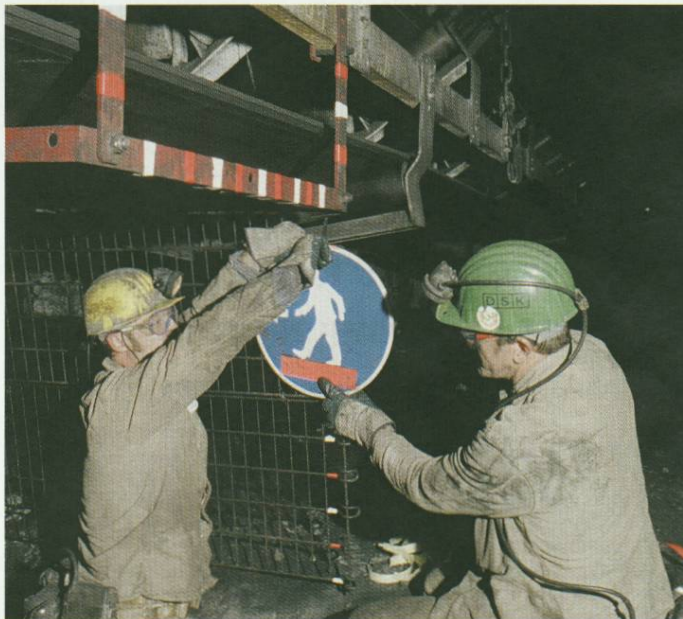
Sorgen für sichere Fahrwege in der neuen Verbundstrecke von Haltern nach Auguste Victoria 3/7: Die beiden Sicherheitssteiger Kersten Büchner (l.) und Dieter Treek (r.) sichern den Untergang unter einem Transportband mit einem reflektierenden Schild.
