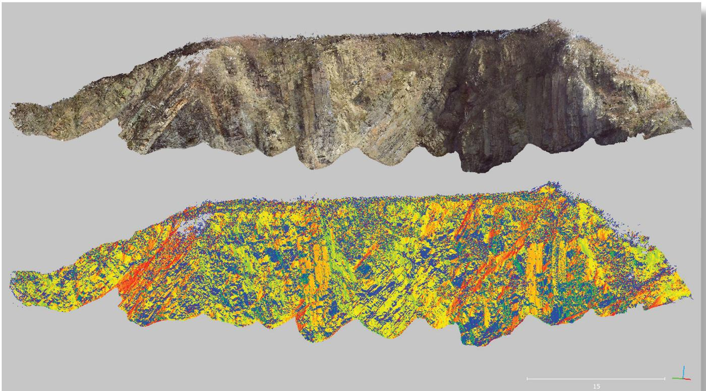
*Mit Laserscan-Technologie erzeugtes virtuelles Modell des Geotops Hagen-Vorhalle; oben Farbkodiert nach RGB-Farbwerten, unten Farbkodiert nach unterschiedlichen Trennflächenorientierungen*
