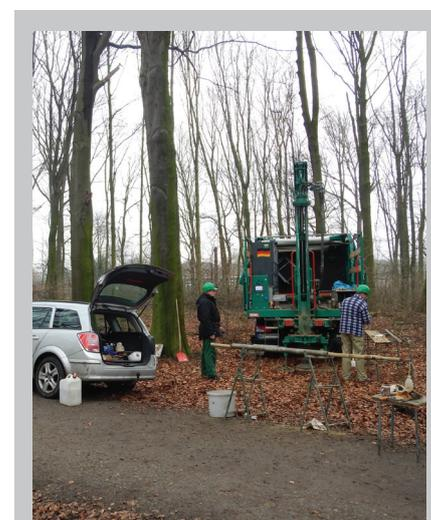
Bohrgerät des GD NRW bei einer 15 m-Bohrung in der Emscher-Niederung bei Bottrop.
