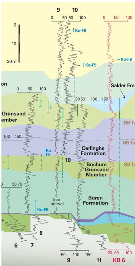
Vergleich von geophysikalischen Messkurven (GR-Logs) von nicht-gekernten Bohrungen (schwarz) mit Messungen aus gekernten Referenzbohrungen (rot) zur stratigraphischen Einstufung im Kreide-Deckgebirge (aus: Dölling et al. 2014: Fig. 5)
