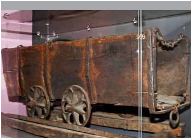
Der älteste erhaltene Grubenwagen des Reviers stammt aus dem frühen 19. Jahrhundert (Foto: LWL/Holtappels)
