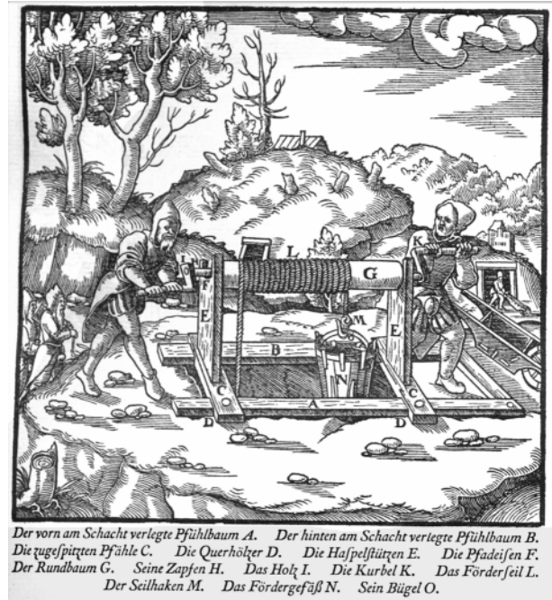
Abb. 10: Zweimännischer Handhaspel, seit Jahrtausenden unverändertes Förderprinzip
