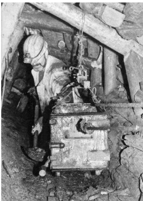
Abb. 174 Beladung eines Hängebahnbehälters vor Ort
