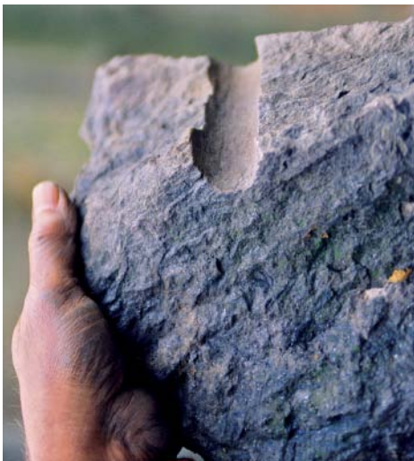
Abb. 96 Handgeschlagenes Sprengbohrloch in einem Wurzelbodenstück
