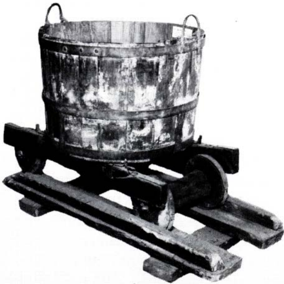
Abb. 55: Deutscher Rollgestellwagen auf „deutscher Wagenleitung“ (Zeche „Schwarzes Pferd“ bei Witten)
