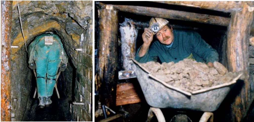
Abb. 169 PETER ARNOLD mit der Schubkarre im nur 1,46 m hohen Förderstollen Schleifmühle
