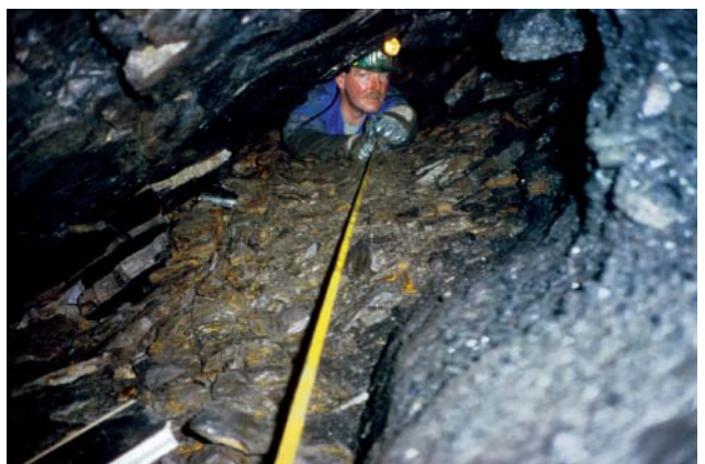
Abb. 126 Vermessung der halb verbrochenen „Fuchsbaustrecke“ mit VOLKER KARL
