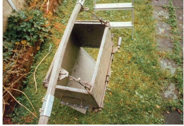
Abb. 173 Probeaufbau der Einschienenhängebahn über Tage
