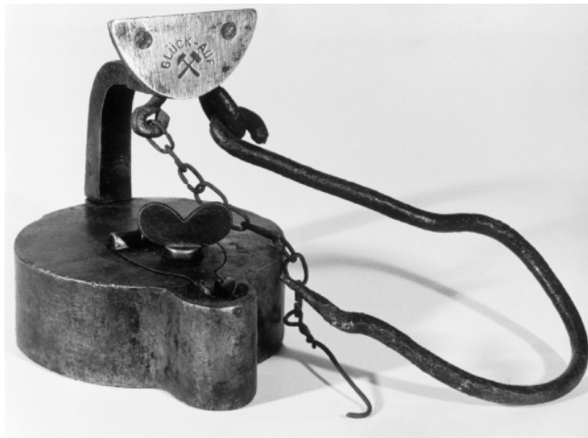
Abb. 189 Rüböl-Grubenlampe, sog. „Westfälischer Frosch“
