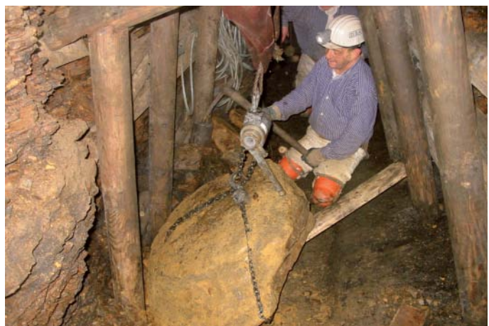
Abb. 4 Toneisenstein-Geode von ca. 300 kg Gewicht aus dem Hangenden von Fl. Sengsbank (Abbaustrecke Graf Wittekind nach SW)
