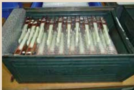
14 mit Folie geschützt werden die Schaltmesser zur Weitermontage in Metallkisten je 120 Stück gepackt...
