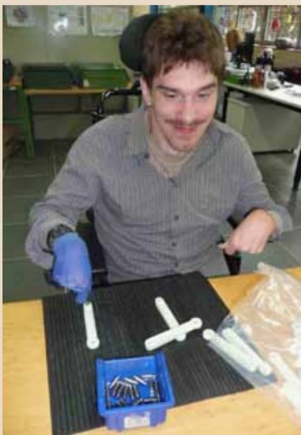
4 ein Bolzen wird auf der richtigen Seite in die Kupplung geschoben...
