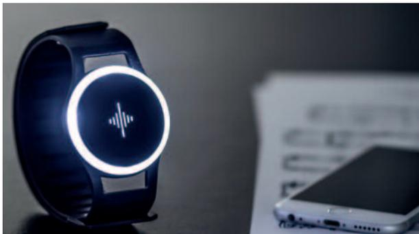
Mit Soundbrenner Pulse entwickelte ein Berliner Start-up ein Wearable speziell für Musiker. Das vibrierende Metronom gleicht einer Armbanduhr und kann so direkt am Fuß, am Oberarm oder anderswo am Körper befestigt werden. Mit Hilfe der Vibrationen wird der Takt an den Körper weitergegeben, ist der Rhythmus spürbar. Das ist vor allem für die Mitglieder einer Band interessant, denn so können alle Mitglieder dasselbe Metronom-Signal nutzen und bleiben besser im Timing.
