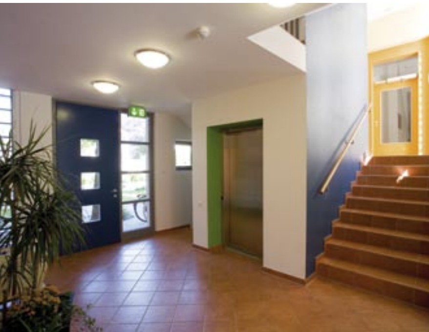
Ausreichender Bewegungsraum vor dem Aufzug vereinfacht den Ein- und Ausstieg. Runde Straße, Rheine
