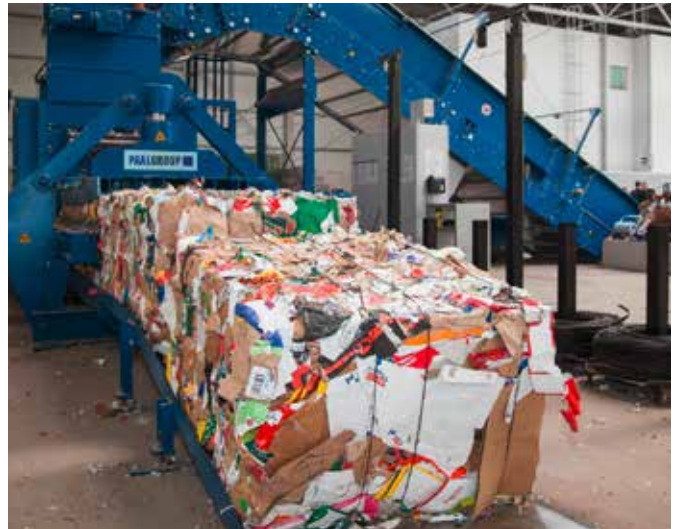
Die Kanalballenpresse der Rieck Entsorgungs-Logistik.
