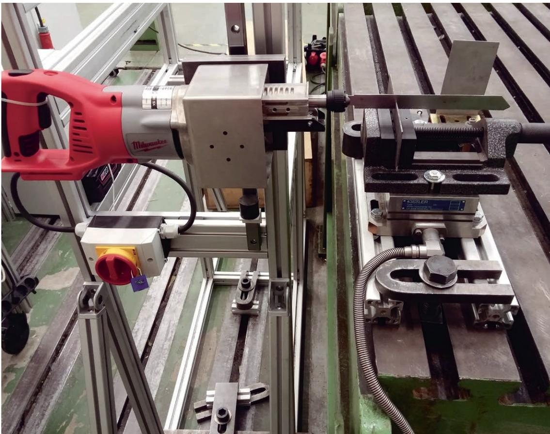
PRÜFSTAND FÜR SÄGEVERSUCHE
