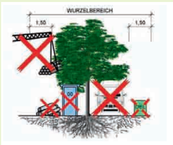
Schutz von Bäumen bei vorübergehender Grundwasserabsenkung
