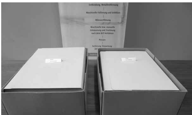
Links vier Jurismappen à 200 Blatt in einem Archivkarton nach der neuen Glättungsmethode. Die Papiere passen ohne Probleme in den Archivkarton. Es ist noch der notwendige Platz für die Handhabung vorhanden. Rechts vier Jurismappen à 200 Blatt in einem Archivkarton nach der alten Glättungsmethode. Die Papiere passen nicht mehr in den Karton.
