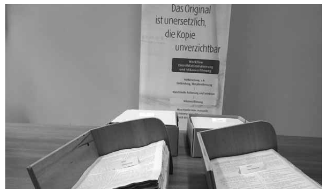
Links 200 Blatt nach der neuen Glättungsmethode. Der Papierstapel ist niedriger und die Papiere sind weniger wellig. Rechts 200 Blatt nach der alten Glättungsmethode. Der Papierstapel ist höher und die Papiere sind welliger.
