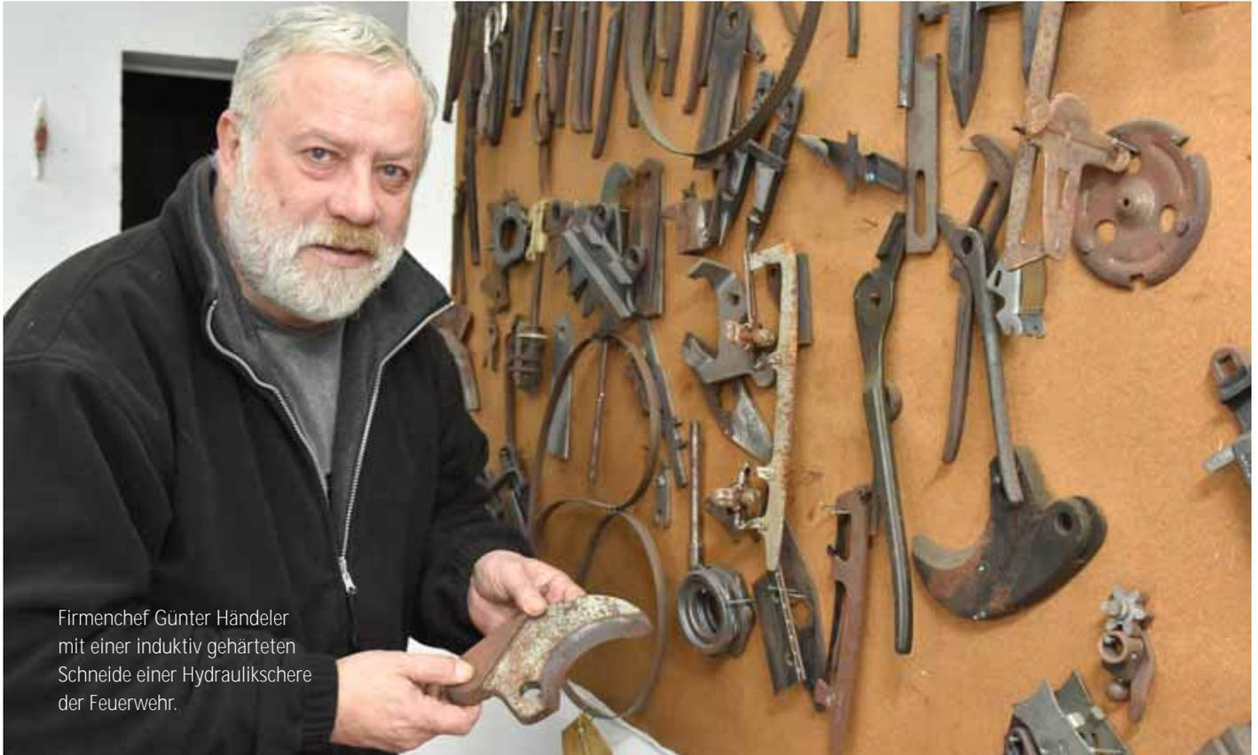
Firmenchef Günther Händler mit einer induktiv gehärteten Schneide einer Hydraulikscheren der Feuerwehr.
