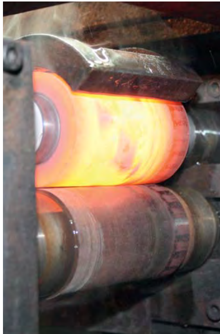
Die obere Rolle des vom BFI entwickelten 2-Zylinder-Heiß-Prüfstands wird erwärmt, um das Walzgut zu simulieren; die untere Rolle steht für die Arbeitswalze im Walzgerüst.
