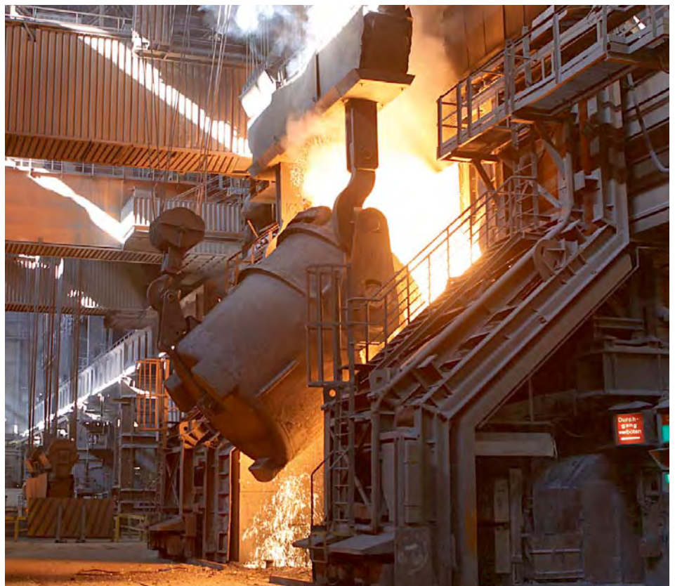
Chargieren von Roheisen in einen Konverter im Stahlwerk.
