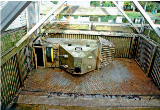
Automatischer Fischzähler in Buisdorf, Sieg
