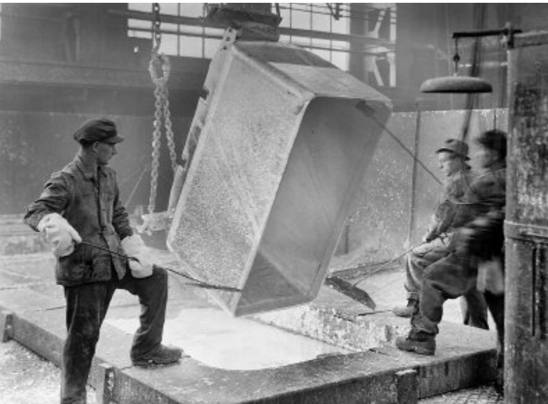
Verzinkung eines Grubenwagens, 1949
