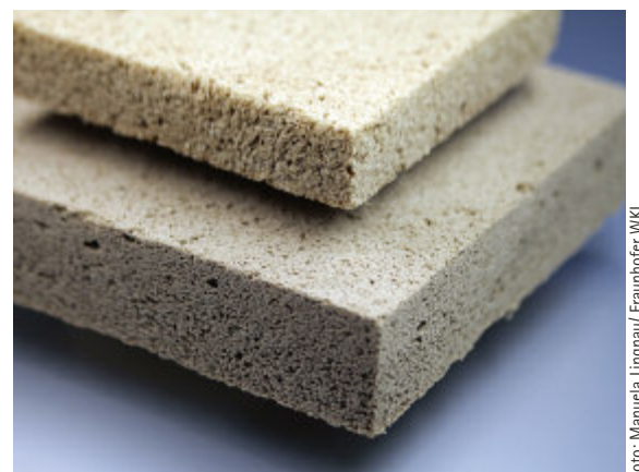
Diese Holzschäumplatte ist ein hundertprozentiges Naturprodukt aus nachwachsenden Rohstoffen.
