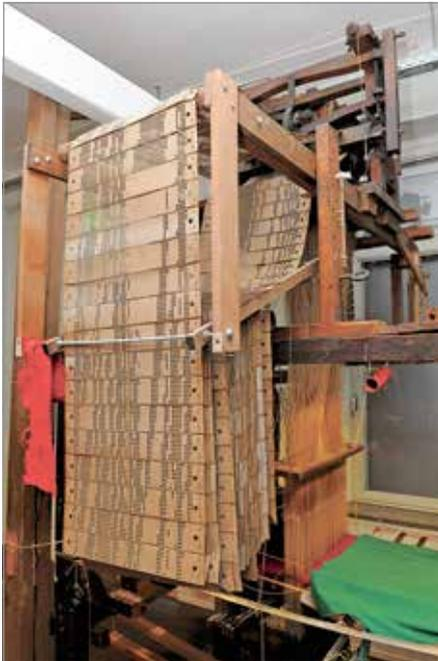
Der französische Erfinder Joseph-Marie Jacquard entwickelte 1804, sehr zum Ärger der „Strippenzieher“ den ersten mechanischen Webstuhl. Er wird durch Lochkarten gesteuert, die bei der Produktion komplexerer Muster in einer Endlosschleife mitlaufen. Die Herstellung solcher „Jacquard-Muster“, die für geistliche Gewänder (Paramente) genutzt wurden, war ein wichtiger Schritt auf dem Weg zur Digitalisierung.
