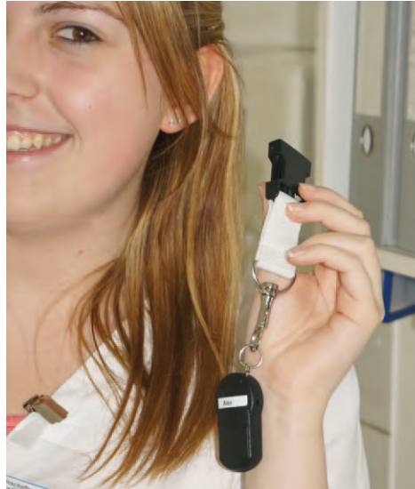
In Abwesenheit eines „Keys“ ist der Computer verriegelt. Er kann dann nur per Passwort aktiviert werden.
