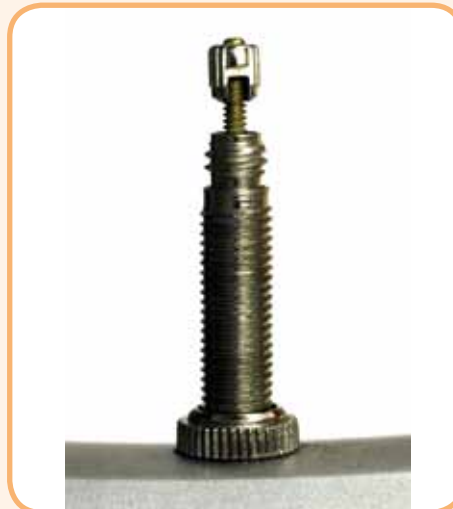
▲ Abbildung 5: Geöffnetes Sclaverand-Ventil
