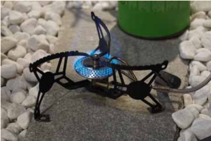
▲ Gaskocher. Das Gas wird über eine „Schlaufe“ (Generator genannt) erwärmt. So kann man die Kartusche auf den Kopf stellen und das flüssige Gas verbrennen, wenn es kalt ist oder nur noch wenig Gas in der Kartusche ist.
