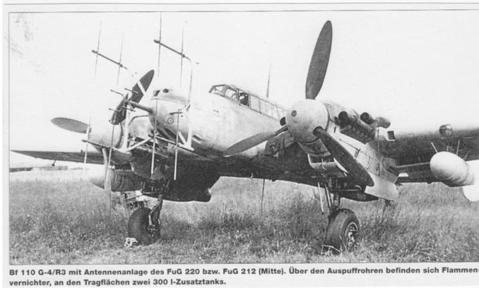
Bf 110 G-4/R3 mit Antennenanlage des FuG 220 bzw. FuG 212 (Mitte). Über den Auspuffrohren befinden sich Flammenvernichter, an den Tragflächen zwei 300 l-Zusatztanks.
