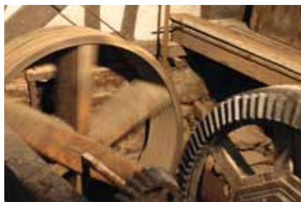
oben: Wipperkotten unten: Kammrad als Antrieb für Schleifsteine
