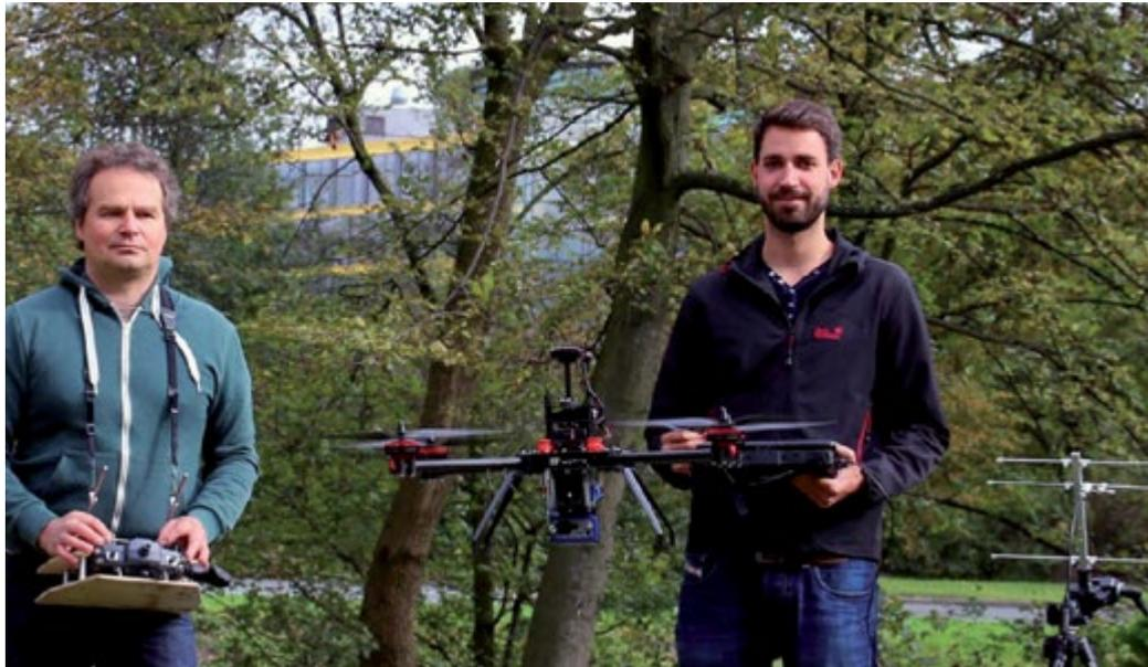
*Christian Fischer (l.) und Martin Lange vom Labor für Umweltmesstechnik der FH Düsseldorf zeigen eine Hightech-Drohne im Einsatz: Ausgerüstet mit GPS, Telemetrie und einem Aethalometer zur Bestimmung der Rußpartikelkonzentration im unteren Luftraum.*
