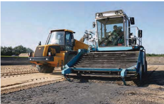
Reinigung Sand- filterbecken mit Aktivkohleauflage
