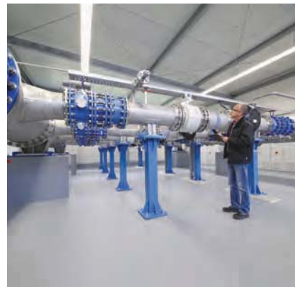
Pilotanlage Echthausen: Edelstahlsäulen mit Mehrschichtfiltern bzw. Aktivkohlefiltern
