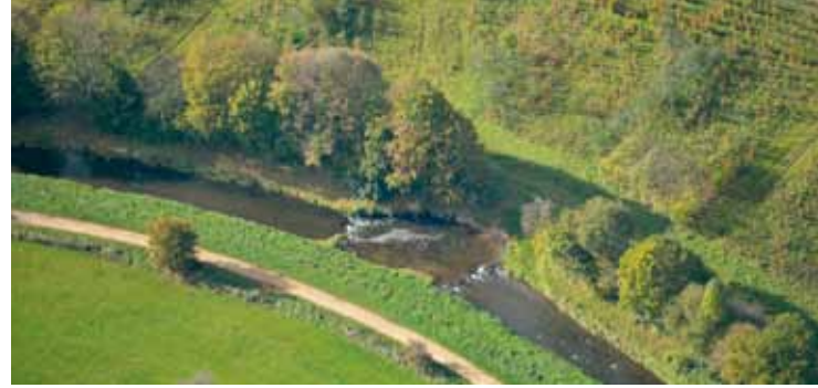
Entnahme von Uferbefestigungen und Zulassen einer eigen-dynamischen Entwicklung der Erft bei Weilerswist.
