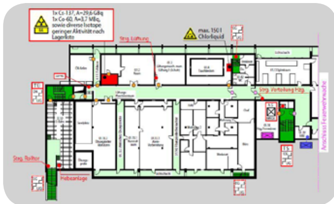
Objektplan der Übungsbrandmeldeanlage.
