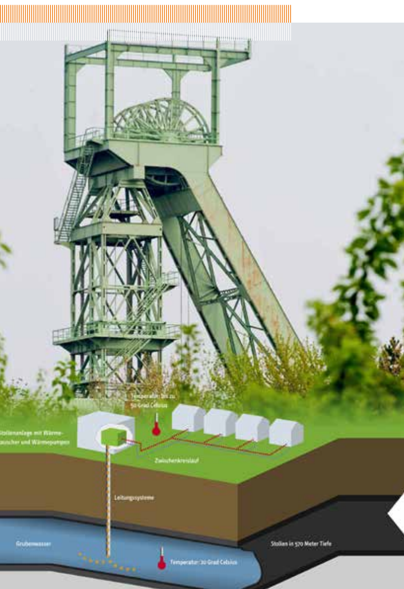
Prinzip der Grubenwassernutzung
