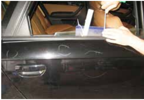
Parkschäden an der Tür werden entfernt...
