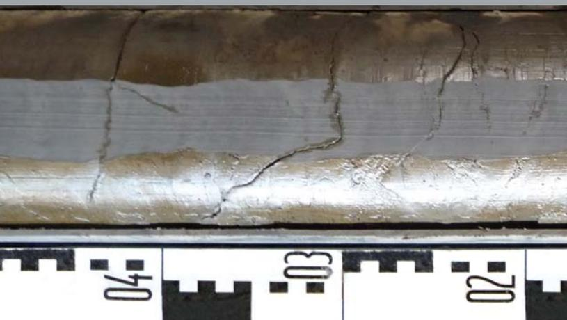
Bohrkernabschnitt mit deutlicher Ölkontamination aus einer Probebohrung
