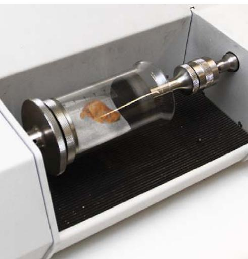
*Probenwechsler des Röntgenfluoreszenz-Spektrometers*
