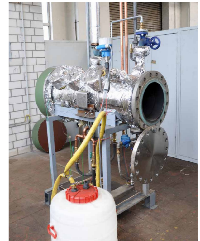
VTC-REAKTOR IM GEÖFFNETEN ZUSTAND: HIER WIRD DIE BIOMASSE UMGEWANDELT.
