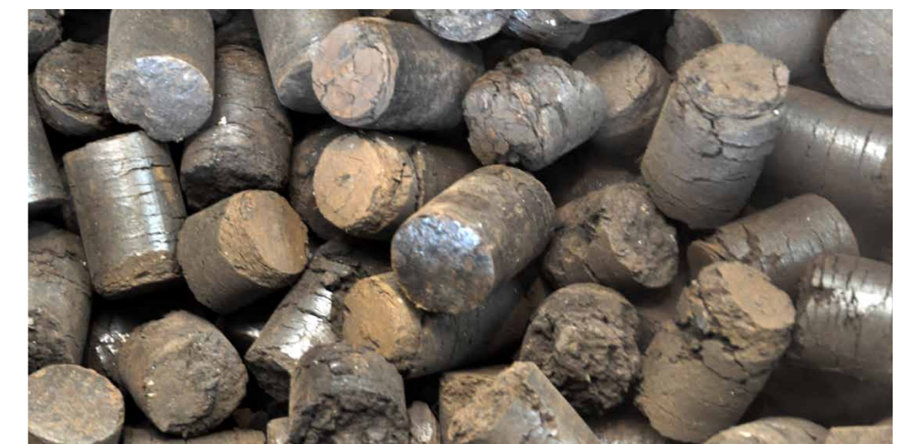
BIOKOHLE-BRIKETS: EINE MÖGLICHE FORM DER BRENNSTOFFKONDITIONIERUNG
