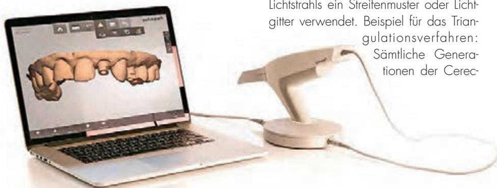
Abb. 2: Trios Scanner als „Tischsystem“: Kamera mit Laptop verbunden. Bild 3Shape
