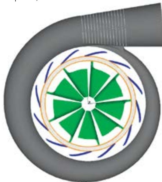
Beispielhafte Darstellung der geplanten Radialturbine (erstellt mit CFturbo).
