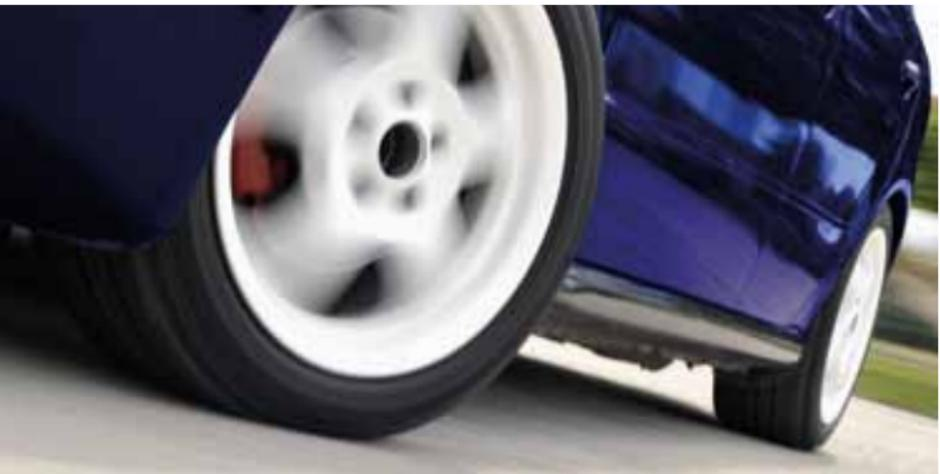
Wenn der Reifen über die Fahrbahnoberfläche abrollt, entstehen Schallwellen durch das Ansaugen und Wegdrücken der Luft. Die Lautstärke hängt vom Reifenprofil und von der Fahrbahnoberfläche ab. Das ist der Grund dafür, dass nur langsam fahrende Elektroautos wirklich leise sind.
