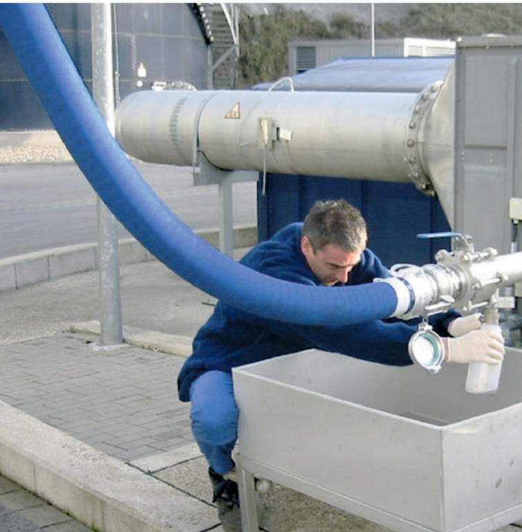
Oben: Speiseabfälle als ein Ausgangsstoff für die Co-Substrate. Unten: Probenahme bei Anlieferung der Co-Substrate.
