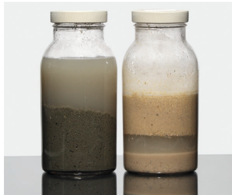
Fettabscheiderinhalte als Co-Substrat.
