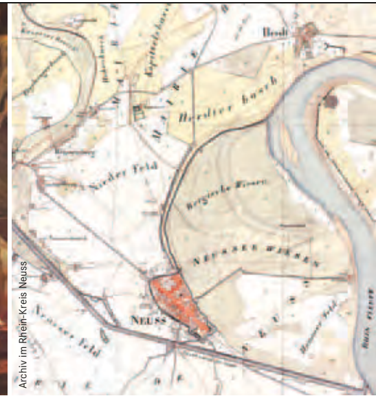
Oben: Karte ca. 1810. Der Kanal begann am heutigen Sporthafen Grimlinghausen. Die Schleuse zum Rhein wurde nie gebaut, trotzdem beförderte man ab 1829 von Neuss bis Neersen u.a. Baustoffe und Kohle. Unten: Zeichnungen aus dem späteren Erläuterungsatlas des Ingenieurs Hageau (1819) sowie Fahrplan von 1846.
