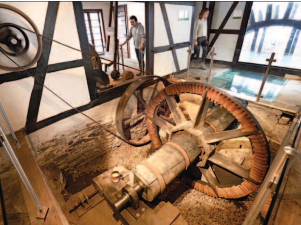
Nicht Strom, sondern Strömung trieb die vielen Schleifkotten an, die es früher an der Wupper gab. Im Balkhauser Kotten wurde die Bewegungsenergie des äußeren Wasserrades durch eine sechs Meter lange Holzwellen auf das innen liegende Kammmrad übertragen.
